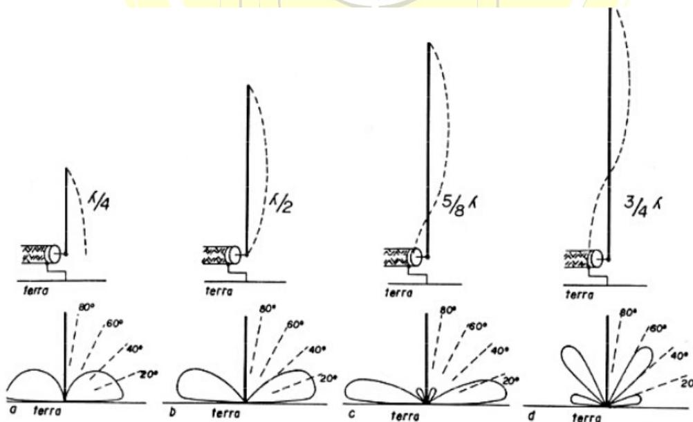
Le antenne hanno ventri di tensione e di corrente molto differenti, e soprattutto hanno lobi di irradiazione principali e secondari con angoli diversi
